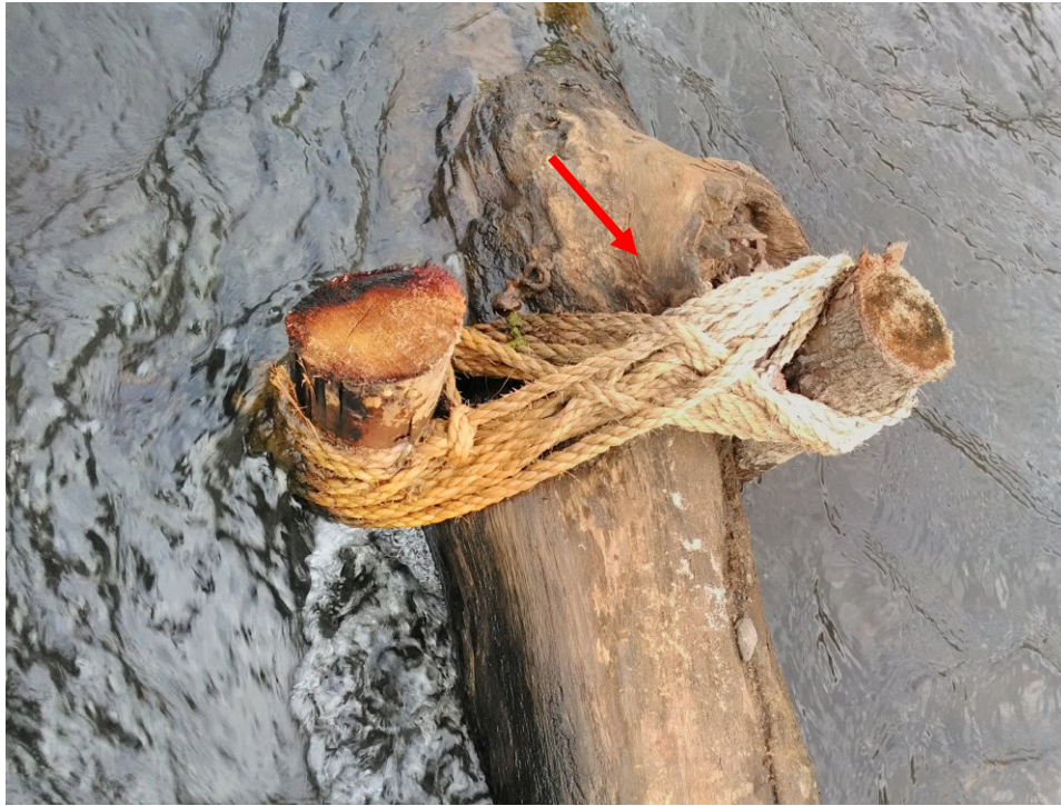
Figura 8 – Integridade do sisal no trecho 6.
