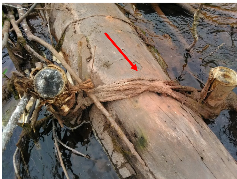
Figura 4 – Integridade do sisal no trecho 7.
